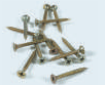
AQUAPANEL® Maxi vijak SN 25 25 mm (za metalne stupove maksimalne debljine 7 mm)*
