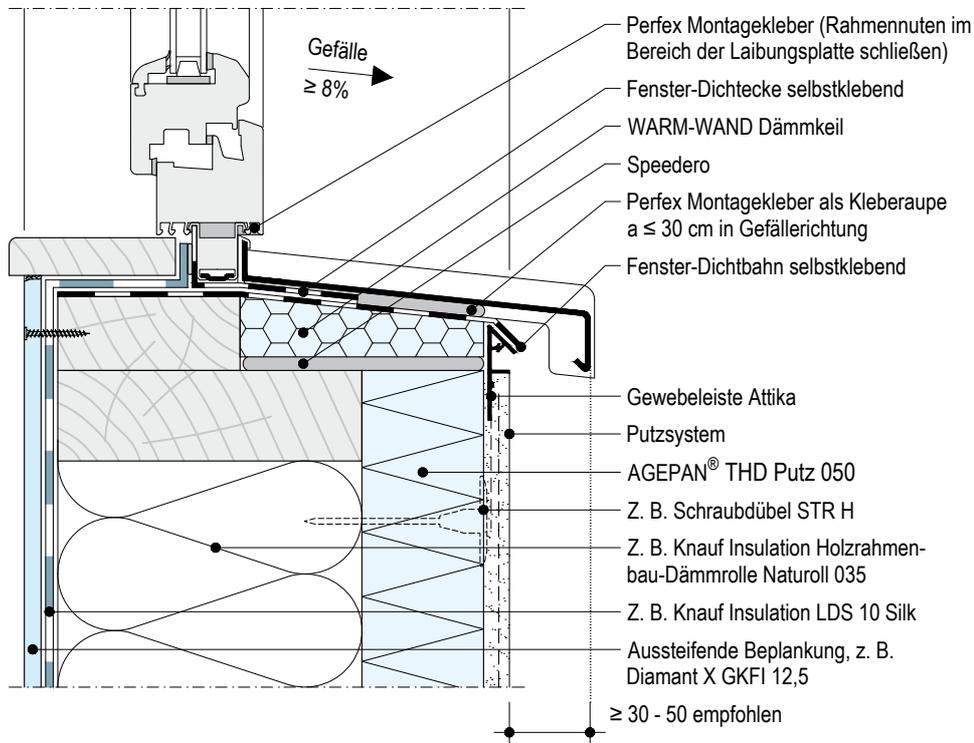
Um eventuell auftretendem Wasser den Abfluss nach außen zu ermöglichen, darf zwischen Vorderkante Fassadendämmung und Unterseite Fensterbank bei Ausbildung einer zweiten wasserführenden Ebene kein Fugendichtband FD eingebaut werden.
